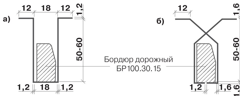
Рисунок 33. Специальные ручные приспособления для установки бортовых камней: а) П-образное приспособление; б) Клещевое приспособление
